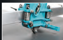
Cornice di taglio regolabile Adjustable cutting frame Long lifetime scoring wheel
