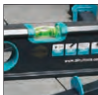
Livello orizzontale per il pavimento
